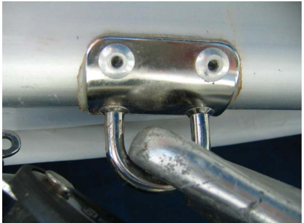
Die Befestigung am Mastfuß erfolgte mit einer geraden Mastplatte
