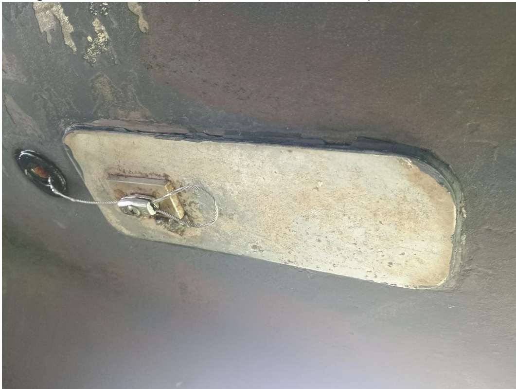
Erdung Bootselektrik Varianta 65 (an Backbord und Steuerbord)
