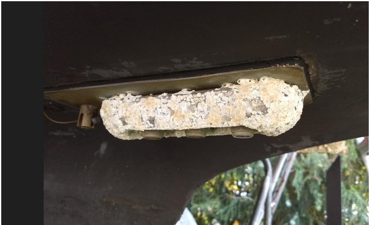
Opferanode unter Varianta nach 6 Monaten Friesland mit Erdung von der Bootselektrik (an Backbord und Steuerbord)
