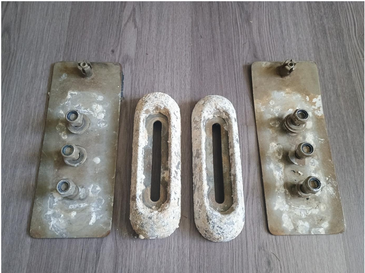
Opferanode unter Varianta nach 6 Monaten Friesland mit Erdung von der Bootselektrik (an Backbord und Steuerbord)
