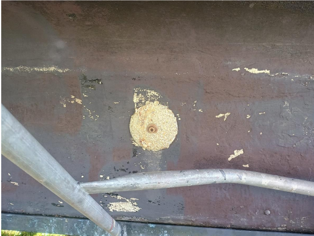
Erdung Bootselektrik Varianta 65 (an Backbord und Steuerbord)
